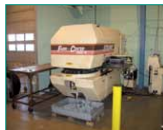
Revolverstanser FABRI-CENTER Stanseeffekt: 20 tons
