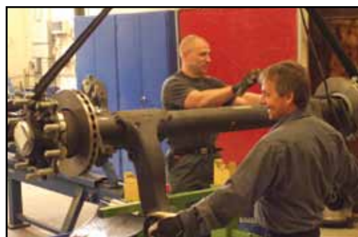
1 Akslen lægges på plads i bænken
